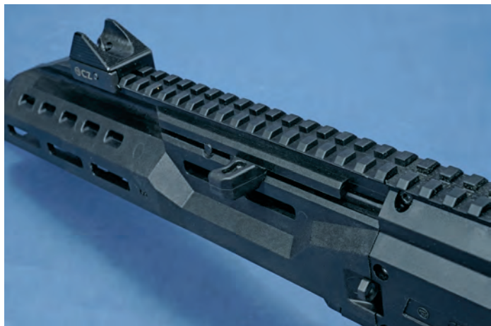
Der Ladehebel kann im Bedarfsfall auch auf der anderen Waffenseite platziert werden. Die eingeklappte Schulterstütze wird mit einem Magneten in ihrer Position fixiert.
