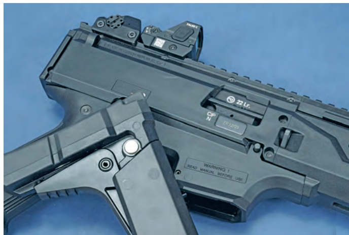
Der Ladehebel kann im Bedarfsfall auch auf der anderen Waffenseite platziert werden. Die eingeklappte Schulterstütze wird mit einem Magneten in ihrer Position fixiert.
